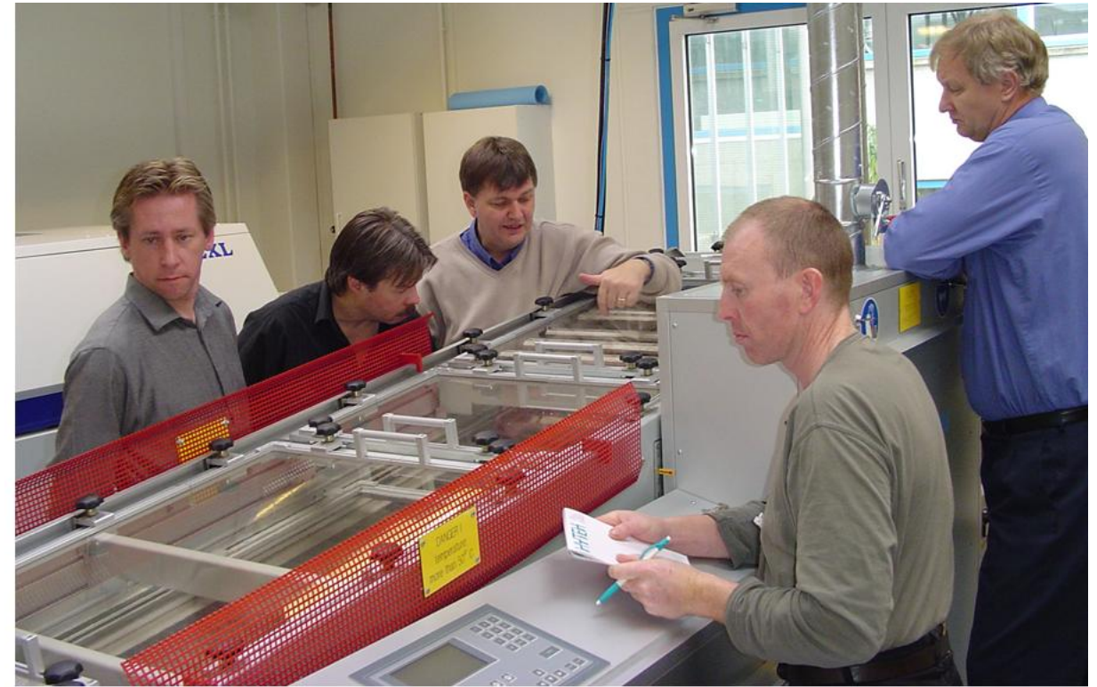
Poul Juul, fra Hytek, forklarer under blyfri bølgelodding i nitrogenatmosfære.
